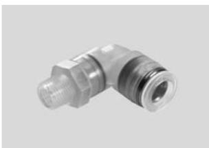
Полипропиленовые штуцеры для использования с агрессивными средами. Для применений пневматики с рабочей температурой до 60 °C и давлением до 10 бар. Шланги с внешним диаметром 4, 6, 8, 10 и 12 мм и присоединительная резьба R1/8 ... R1/2.
