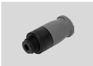
Пластиковые штуцеры для простого монтажа одной рукой. Стойкость к гидролизу, соответствие стандартам Управления по санитарному надзору за качеством пищевых продуктов и медикаментов (FDA). Для применений пневматики с рабочей температурой до 60 °C и давлением до 10 бар. Шланги с внешним диаметром 6 мм и присоединительная резьба G1/8.
