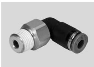
Цанговые штуцеры, вращающиеся на 360°. Шарикоподшипник позволяет штуцеру вращаться с частотой до 500 об/мин. Для применений пневматики в условиях рабочей температуры до 60 °C и давления до 14 бар. Шланги с внешним диаметром 4, 6, 8, 10 и 12 мм и присоединительная резьба M5, R1/8 ... R1/2 и G1/8 ... G1/2.
