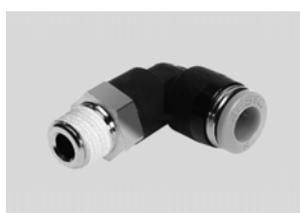
Для основных применений пневматики с рабочей температурой до 60 °С и давлением до 10 бар. Шланги с внешним диаметром 4, 6, 8, 10, 12 и 16 мм и присоединительная резьба M5 и R $\frac{1}{8}$  ... R $\frac{1}{2}$ .
