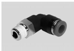
Широкий выбор цанговых штуцеров для применения в условиях рабочей температуры до 80 °С и давления до 14 бар. Шланги с внешним диаметром 4, 6, 8, 10, 12, 16 и 22 мм и присоединительная резьба R $\frac{1}{8}$  ... R $\frac{1}{2}$  и G $\frac{1}{8}$  ... G $\frac{3}{4}$ .
