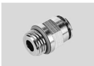
Полностью металлические цанговые штуцеры изготовлены из никелированной латуни. Высокая стойкость к коррозии и химикатам (CRC3). Для применений пневматики в условиях рабочей температуры до 150 °C и давления до 20 бар. Шланги с внешним диаметром 4, 6, 8, 10, 12 и 14 мм и присоединительная резьба M5, M7 и G1/8 ... G1/2.
