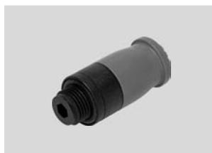
Полимерные штуцеры для простого монтажа одной рукой. Стойкость к гидролизу, соответствие стандартам Управления по санитарному надзору за качеством пищевых продуктов и медикаментов (FDA). Для применений пневматики с рабочей температурой до 60 °C и давлением до 10 бар. Шланги с внешним диаметром 6 мм и присоединительная резьба G1/8.
