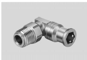
Цанговые штуцеры из нержавеющей стали. Высокая стойкость к коррозии (CR4) и химическая стойкость, одобрены для использования в пищевой и упаковочной промышленности. Для применений пневматики в условиях рабочей температуры до 120 °С и давления до 10 бар. Шланги с внешним диаметром 4, 6, 8, 10, 12 и 16 мм и присоединительная резьба M5 и R $\frac{1}{8}$  ... R $\frac{1}{2}$ .
