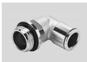
Цанговые штуцеры по привлекательной цене для применения в условиях рабочей температуры до 70 °C и давления до 16 бар. Шланги с внешним диаметром 3, 4, 6, 8, 10, 12 и 14 мм и присоединительная резьба M5, M7 и G1/8 ... G1/2.
