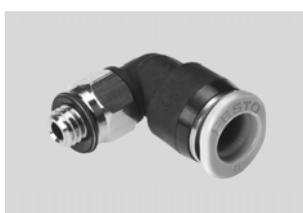
Миниатюрные цанговые штуцеры для максимально плотного монтажа в ограниченном пространстве. Для применений пневматики в условиях рабочей температуры до 60 °С и давления до 10 бар. Шланги с внешним диаметром 3, 4 и 6 мм и присоединительная резьба M3, M5, M7, R $\frac{1}{8}$ .
