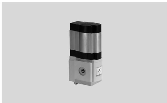
Регулятор давления с электрическим управлением предназначен для поддержания постоянного давления на выходе независимо от колебаний давления на входе и расхода. Выходное давление настраивается непосредственно с помощью встроенного электрического привода. Управление электрическим приводом осуществляется через дискретные входы со штекером M12
