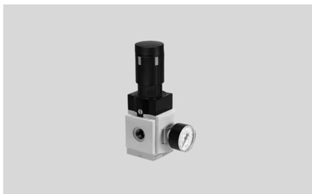
Прецизионный регулятор предназначен для задач высокоточного поддержания уровня давления с гистерезисом 0.02 бар. Давление на выходе p2 может быть настроено в пределах регулировки давления в ручную с помощью поворотной рукоятки или пневматически с помощью задающего сигнала p12,
