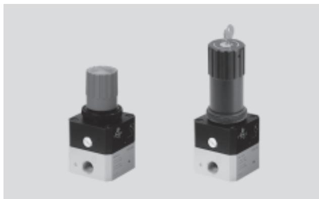
Прецизионный регулятор управляет рабочим давлением (на выходе) с помощью мембранного пилотного клапана, который, воздействуя на главный затвор, улучшает настроечные характеристики.
