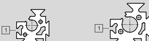
[1] Монтажный паз для датчиков положения
