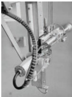
Уровень радиационного излучения до 4 зиверт/час при погружении в полностью опресненную воду руки манипулятора для снятия термической защиты ядерного реактора.
