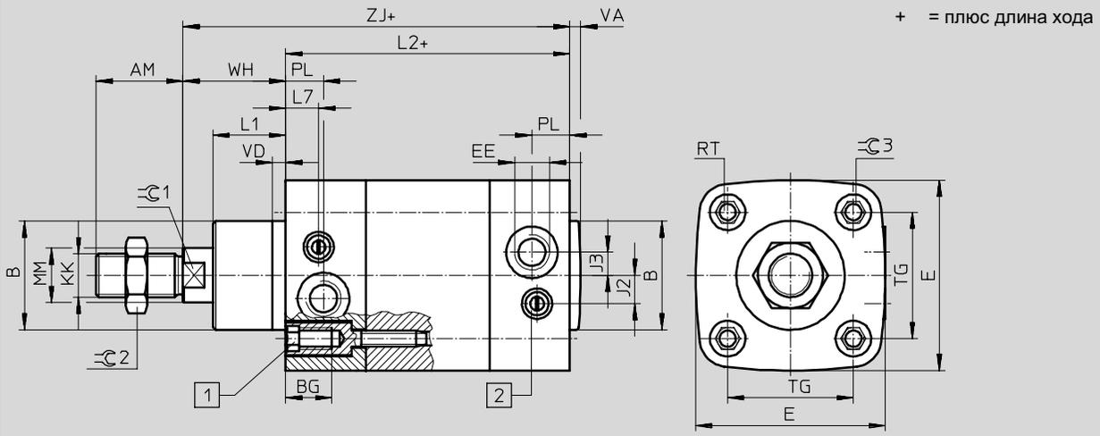
со встроенными в крышки датчиками положения
