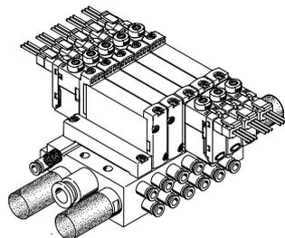
VTUG-Ventilatterie aus VUVG-BK/VUVG-B Anschlussplattenventile
