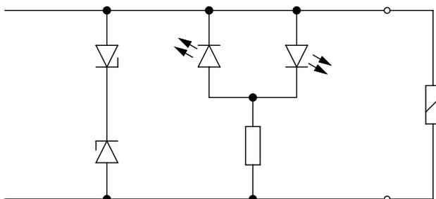
Die Magnetspulen (P-Typ), der 5, 12 und 24 V Ausführungen sind mit einer Schutzbeschaltung zur Funkenlöschung und gegen Verpolung ausgestattet.
