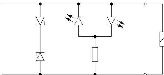
Die Magnetspulen sind mit einer Schutzbeschaltung zur Funkenlöschung und gegen Verpolung ausgestattet.
