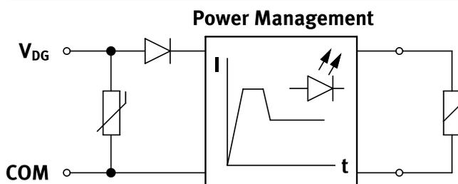
Bei der 24 V DC Ausführung (R-Typ) ist zusätzlich eine Haltestromabsenkung integriert. Die Leistung wird dadurch von 1 W auf 0,35 W reduziert.
