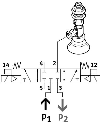
Vakuum, Abwurfimpuls und Ruhestellung können wie folgt realisiert werden:
