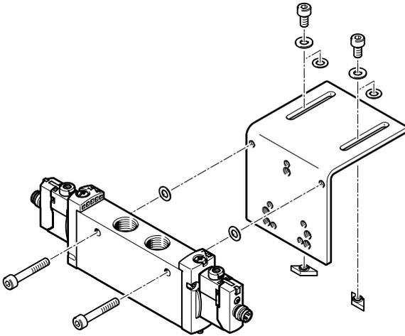
Zur Montage einzelner Ventile direkt an einem Antrieb. Die Magnetventile sind mit zwei Durchgangsbohrungen zur Befestigung an der DAVM-MW-V1...-V Zylinderbefestigung versehen. Die Befestigung ist nur an der Seite, auf der sich die pneumatischen Anschlüsse befinden, möglich.
