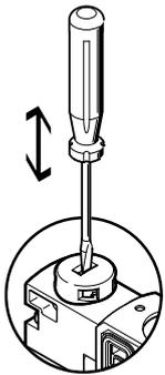
HHB wird durch Drücken mit Stift oder Schraubendreher betätigt und über Federkraft zurückgestellt (rastende Stellung wird durch coodierte Abdeckkappe verhindert).
