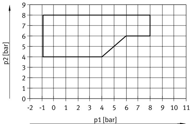
für Polymer-Sitzventil in Baubreite 10 mm mit Code: MU, NU, KU, HU
