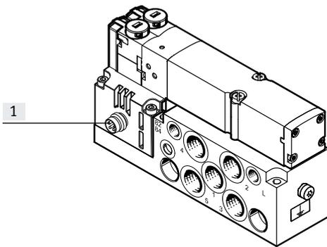
[1] Elektrischer Anschluss, Stecker 4-polig, M8, nach EN 60947-5-2
