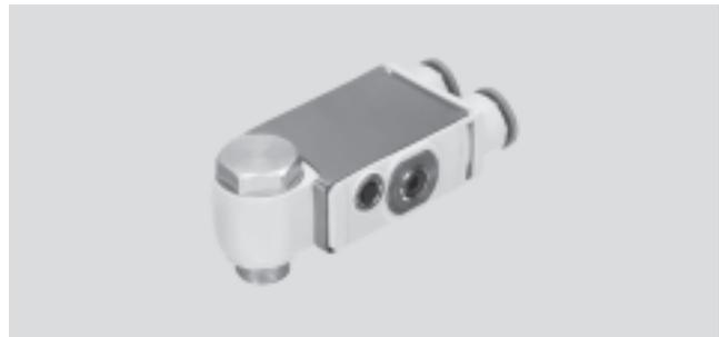
Die Funktionskombination besteht aus einem Drossel-Rückschlagventil und einem entsperrenen Rückschlagventil. Sie dient zur Einstellung der Aus-/Einfahrtsgeschwindigkeit eines Antriebs mit zeitweiligem Zwischenstopp.
