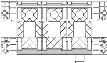
Die CPX-Module werden mit speziellen Zugankern mechanisch miteinander verbunden. Die Befestigung erfolgt mit nur 2 Schrauben in den Endplatten für die gesamte Einheit.
