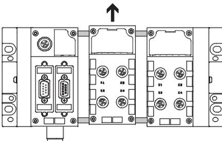
Eine offene Konstruktion erlaubt den Austausch der Verkettungsblöcke im montierten Zustand. Mit dem Zuganker-Erweiterungssatz kann das CPX-Terminal um ein Modul erweitert werden.
