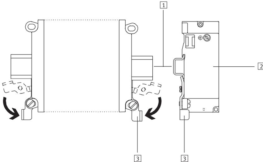
Die Ventilinsel wird in die Hutschiene eingehängt und mit den Schwenkhebel arretiert.
