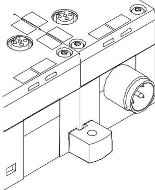
Für längere Ventilinseln stehen zusätzliche Befestigungswinkel (für das CPX-Terminal) zur Verfügung, die in jedem Modul angebracht werden können.
