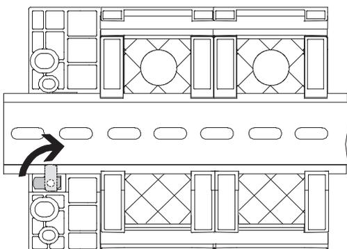
Im rückwärtigen Profil der (CPX-)Module ist die Hutschiennenmontage eingepreßt. Über die Hutschienebefestigungen lassen sich die Module auf der Hutschiene verriegeln.
