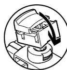
Abdeckung auf Vorsteuerventil aufclipsen. Danach wird die HHB durch Verschieben des Schieber der Abdeckkappe betätigt.
