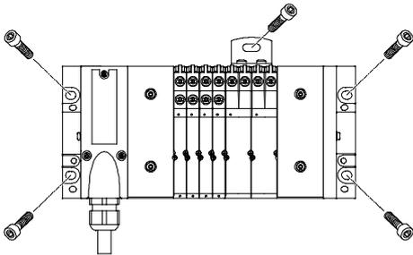
Die MPA-F Ventilinsel wird mit vier M6-Schrauben auf der Befestigungsfläche angeschraubt. Die Montagebohrungen befinden sich am Pneumatik-Interface und an
