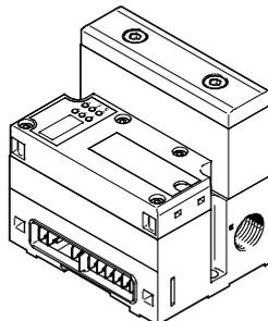
Die Ventilinsel MPA-F kann an einer oder mehreren Stellen mit Druck versorgt werden. So wird auch bei größerem Ausbau eine gute Performance aller Funktionskomponenten sicher gestellt. Die Versorgung der Ventilinsel wird über die linke Endplatte oder Einspeisemodule vorgenommen. Die Entlüftung 3/5 geschieht wahlweise über Schalldämpfer oder Anschlüsse für gefasste Abluft auf den Einspeisemodulen und auf der linken Endplatte.
