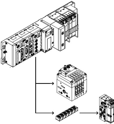
Die optionale Strangerweiterung bietet die Möglichkeit, weitere Ventilinseln und E/A-Module an den Feldbusknoten des CPX-Terminals anzuschließen. Es können verschiedene Ein- und Ausgangsmodule und CPV-SC, CPV-, CPA-Ventilinseln angeschlossen werden.
