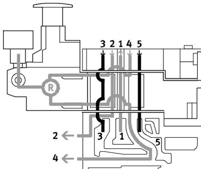
Dieser Druckregler regelt den Druck im Kanal 4 nachdem das Druckmedium durch das Ventil geströmt ist. Beim Entlüftungsvorgang wird im Ventil über den Druckregler von Kanal 4 nach Kanal 5 entlüftet.
