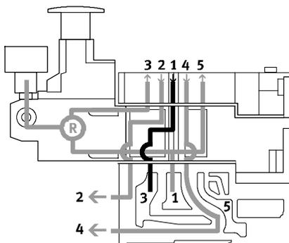
Der reversible B-Regler splittet die Arbeitsluft im Kanal 1 auf und regelt den Druck vor dem Ventil in den Kanal 3 (im Kanal 5 steht der ungeregelte Druck aus Kanal 1 an). Danach wird die geregelte Luft auf den Kanal 2 geregelt. Das Ventil wird dadurch reversibel betrieben.
