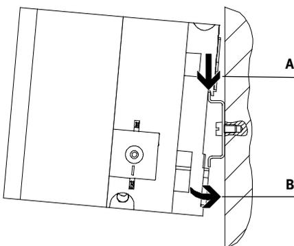
Die MPA-F Ventilinsel wird in die Hutschiene eingehängt (siehe Pfeil A). Danach wird die MPA-F Ventilinsel auf die Hutschiene geschwenkt und durch Klemmstücke befestigt (siehe Pfeil B).
