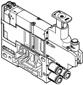
Auf jedem Ventilplatz können zwischen Grundplatte und Ventil weitere Funktionseinheiten eingefügt werden.
