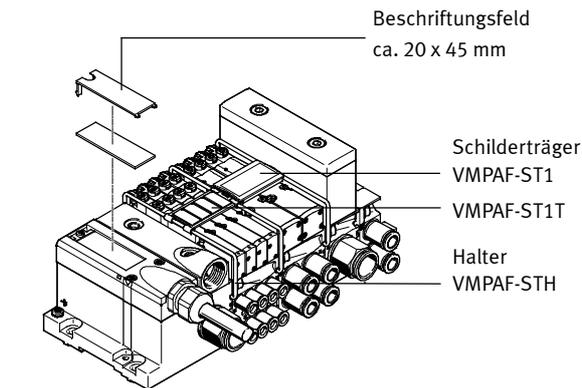
Zur Beschriftung der Ventile kann an jedem Anschlussblock ein Schilderträger VMPAF-ST1 (Teile-Nr. 546 228, Code T im Bestellcode, mit Papierschild bestückbar) oder VMPAF-ST1T (Teile-Nr. 544 422, mit Beschriftungsschildern IBS-9x20 bestückbar) montiert werden. Alternativ oder ergänzend dazu können großflächige Bezeich-
