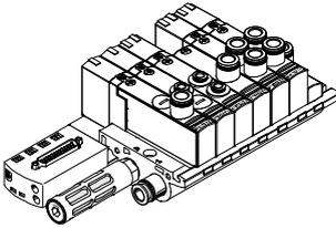
Die Signalansteuerung von der Steuerung zur Ventilinsel erfolgt über ein mehradriges vorkonfiguriertes Kabel. Dadurch wird der Installationsaufwand erheblich reduziert.
