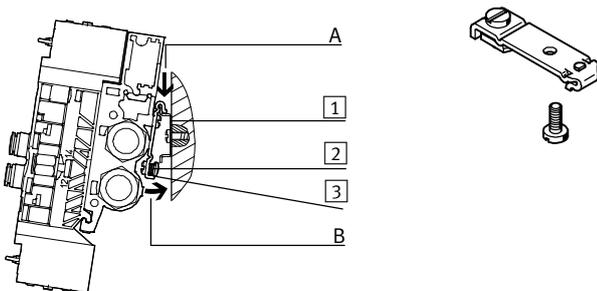
Die VTUB Ventilinsel wird in die Hutschiene eingehängt (siehe Pfeil A).
