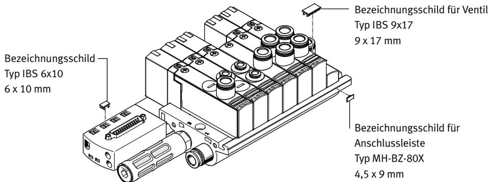
Zur Kennzeichnung der Ventile und der Anschlussleisten können Bezeichnungsschilder montiert werden.
