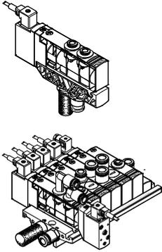
Unabhängig von der Steuerung flexibel anschließbar mit vorkonfigurierten Kabeln. Es gibt zwei verschiedene Ventilarten, Muffenventile und Halbmuffenventile für Anschlussleisten oder Einzelanschlussplatten. Bei Einzelanschluss kann zwischen 2 ... 20 Magnetspulen (aufgeteilt auf 2 ... 10 Ventilplätze) gewählt werden.
