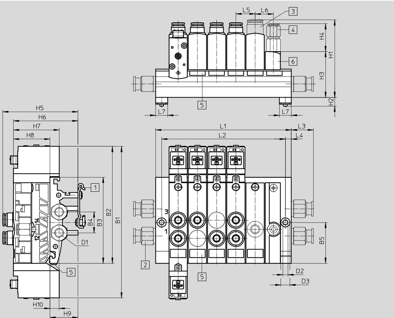
1 Befestigung für Tragschiene NRH-35-2000 (optional)
