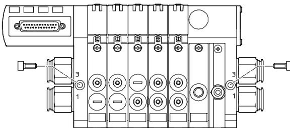
Die VTUB Ventilinsel wird mittels zwei M5-Schrauben auf der Befestigungsfläche angeschraubt.
