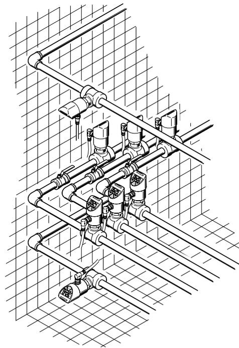
Druckerfassung in Filteranlagen
