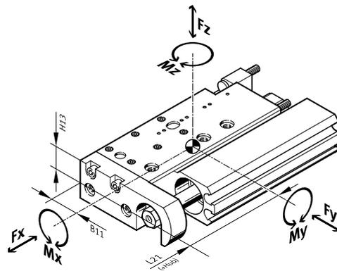
Wirken gleichzeitig mehrere der unten genannten Kräfte und Momente auf den Antrieb, müssen neben den aufgeführten Maximalbelastungen folgende Gleichung erfüllt werden:
