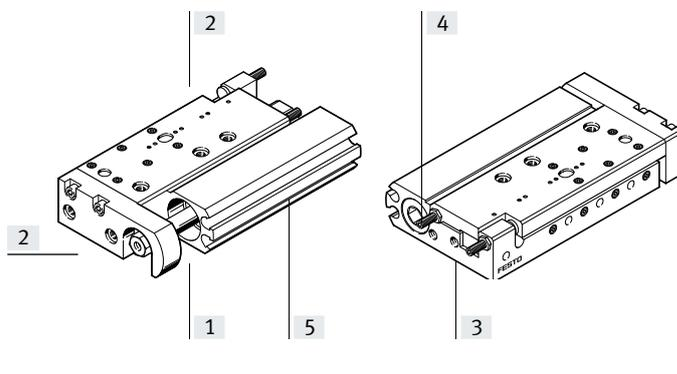
[4] Justierbare Endlagendämpfungssysteme bei SLF-...-P-A mit elastischen Dämpfungselementen in den Endlagen
