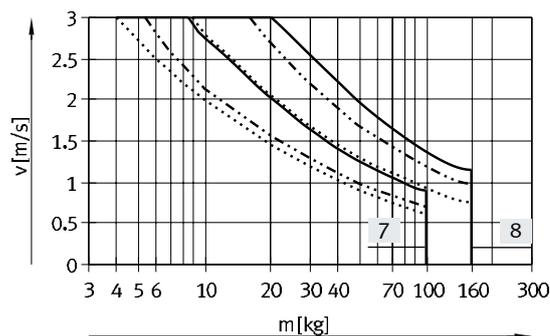
Für jeden Stoßdämpfer sind drei Kraftkurven eingezeichnet. Für Zwischenwerte muss gemittelt werden.
