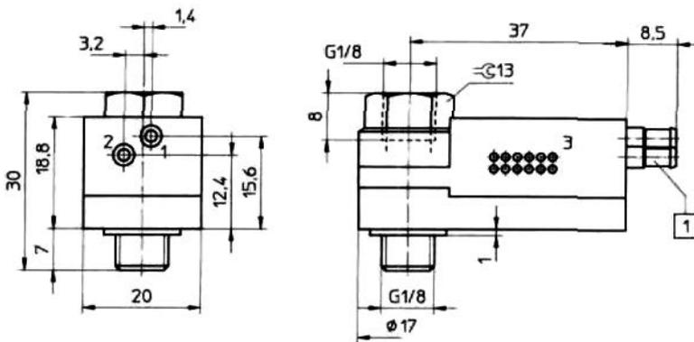
[1] Stecknippel für Kunststoffschlauch NW3
