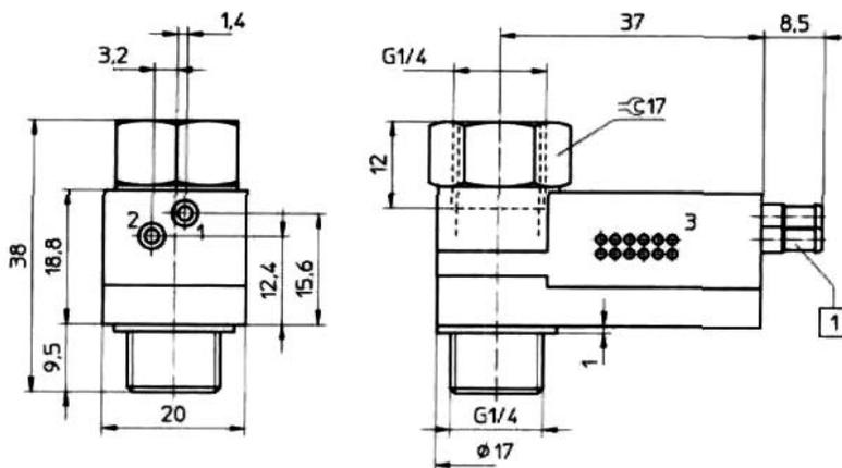
[1] Stecknippel für Kunststoffschlauch NW3
