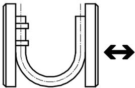
Der auf der Grundplatte fixierte Schlauch wird solange gebogen bis die Deformierung zum Knick führt. Der gemessene Wert ist der minimale Biegeradius  $R_{min}$ . Dieser  $R_{min}$  führt zu erheblichen Durchflussreduzierungen.
