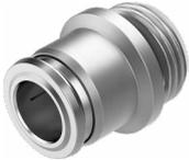
Edelstahlsteckverschraubung. Höchste Korrosionsbeständigkeit KBK4 und Chemikalienresistenz. Für Pneumatikanwendungen mit einem Temperaturbereich bis 150 °C und einem Druckbereich bis 16 bar. Schlauch-Außen- $\varnothing$  4, 6, 8, 10 und 12 mm mit Anschlussgewinde M5, M7 und G1/8 ... G1/2.
