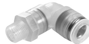
Polypropylenverschraubung für den Einsatz bei Anwendungen mit extremen Medieneinflüssen. Für Pneumatikanwendungen mit einem Temperaturbereich bis 60 °C und einem Druckbereich bis 10 bar.
