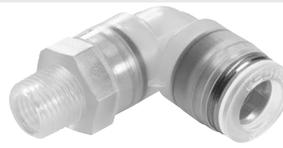
Polypropylenverschraubung für den Einsatz bei Anwendungen mit extremen Medieneinflüssen. Für Pneumatikanwendungen mit einem Temperaturbereich bis 60 °C und einem Druckbereich bis 10 bar. Schlauch-Außen- $\varnothing$  4, 6, 8, 10 und 12 mm mit Anschlussgewinde von R1/8 ... R1/2.
