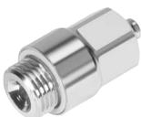
Edelstahlverschraubung für den Einsatz in reinigungsintensiven Bereichen. Höchste Korrosionsbeständigkeit KBK4. Für Pneumatikanwendungen mit einem Temperaturbereich bis 120 °C und einem Druckbereich bis 12 bar. Schlauch-Außen- $\varnothing$  4, 6, 8 und 10 mm mit Anschlussgewinde M5 und G1/8 ... G3/8.
