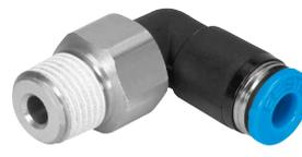
Steckverschraubung mit Schwenkanschluss, 360° rotierend. Das Kugellager ermöglicht rotierende Bewegungen in der Anwendung bis max. 500 U/min. Für Pneumatikanwendungen mit einem Temperaturbereich bis 60 °C und einem Druckbereich bis 14 bar. Schlauch-Außen- $\varnothing$  4, 6, 8, 10 und 12 mm mit Anschlussgewinde M5, R1/8 ... R1/2 und G1/8 ... G1/2.
