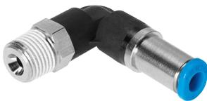
Steckverschraubung sperrt Luftstrom nach dem Lösen des Schlauchs. Für Pneumatikanwendungen mit einem Temperaturbereich bis 60 °C und einem Druckbereich bis 14 bar. Schlauch-Außen- $\varnothing$  4, 6, 8, 10 und 12 mm mit Anschlussgewinde M5, R1/8 ... R1/2 und G1/8 ... G1/2.
