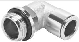
Metallsteckverschraubung zum attraktiven Preis für Pneumatikanwendungen mit einem Temperaturbereich bis 70 °C und einem Druckbereich bis 16 bar. Schlauch-Außen- $\varnothing$  3, 4, 6, 8, 10, 12 und 14 mm mit Anschlussgewinde M5, M7 und G1/8 ... G1/2.
