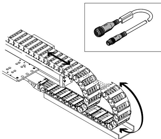
Bei Schleppketten-Applikationen treten hohe mechanische Belastungen auf, insbesondere wenn sehr kleine Schleppkettenradien notwendig sind. Die Verbindungsleitung kann in einem Umfeld eingesetzt werden, bei dem sie einer ständigen Verbiegung ausgesetzt ist. Der Kabelmantel der Verbindungsleitungen besteht aus Polyurethan und ist halogenfrei, ölbeständig und optimiert für Verlegung in Kontakt mit pneumatischen Schläuchen; frei von Phosphorsäureester
