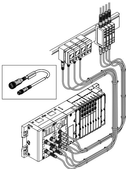
Standard-Applikationen sind gekennzeichnet durch feste Kabelverlegung oder geringe bis mittlere mechanische Belastungen. Die Verbindungsleitung kann sogar für einfachere Schleppkettenanwendung mit größeren Radien eingesetzt werden. Der Kabelmantel der Verbindungsleitungen besteht aus Polyurethan und ist halogenfrei, ölbeständig und optimiert für Verlegung in Kontakt mit pneumatischen Schläuchen; frei von Phosphorsäureester
