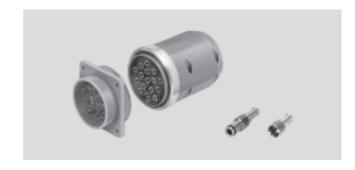
Die Stecker- und Buchsenplätze sind nummeriert und beim Kuppeln durch eine Führungsnase unverwechselbar einander zugeordnet. Die Kupplung wird durch einen Schraubring zusammengezogen und gesichert.
