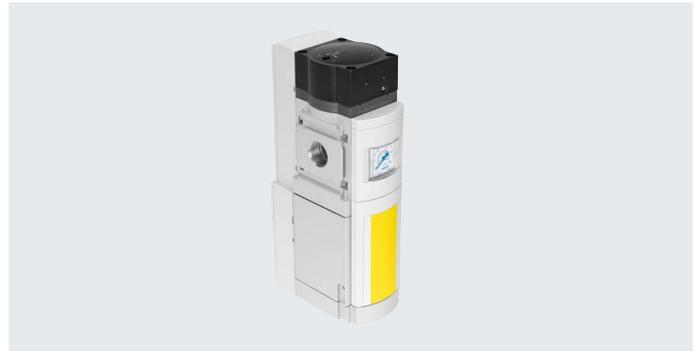
Das elektropneumatische Druckaufbau- und Entlüftungsventil dient dem schnellen und sicheren Druckabbau und dem sanften Druckaufbau in pneumatischen Leitungssystemen und Endgeräten der Industrie. Bei dem Gerät handelt es sich um ein selbsttestendes, redundantes mechatronisches System nach
