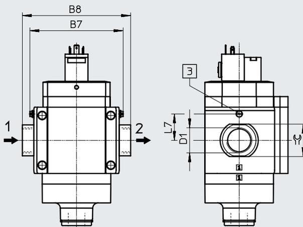
[1] Befestigungsschraube M6xmin.90 nach DIN 912 (nicht im Lieferumfang enthalten) zur Wandmontage ohne Befestigungswinkel → Durchflussrichtung
