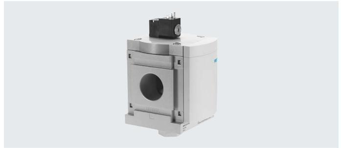
Die Dauer des Druckaufbaus wird über die am Ventildeckel angebrachte Drossel eingestellt. Entsprechend der eingestellten Drosselstellung steigt der Ausgangsdruck  $p_2$  langsam an. Solange das Magnetventil nicht betätigt wird, steht nur der Durchfluss der Drossel zur Verfügung. Erst durch Bestromen des Magnetventils wird der Hauptsitz geöffnet.
