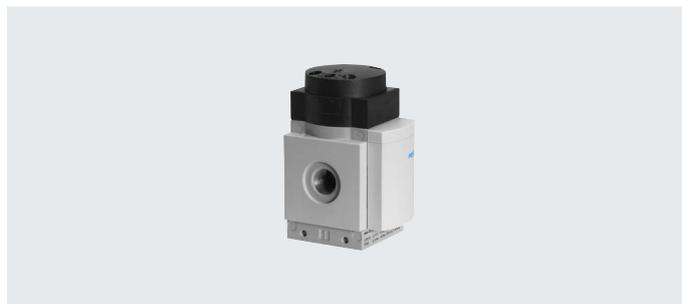
Die Dauer des Druckaufbaus wird über die am Ventildeckel angebrachte Drossel eingestellt. Entsprechend der eingestellten Drosselstellung steigt der Ausgangsdruck  $p_2$  langsam an. Bei Erreichen des Durchschaltdrucks öffnet der Hauptsitz.
