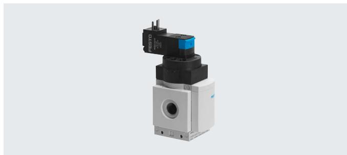
Die Dauer des Druckaufbaus wird über die am Ventildeckel angebrachte Drossel eingestellt. Entsprechend der eingestellten Drosselstellung steigt der Ausgangsdruck p2 langsam an. Solange das Magnetventil nicht betätigt wird, steht nur der Durchfluss der Drossel zur Verfügung. Erst durch Bestromen des Magnetventils wird der Hauptsitz geöffnet.
