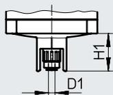
Steckanschluss für Kunststoffschlauch PUN-6/PAN-6
