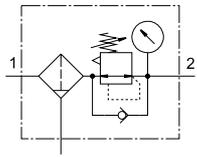
Kondensatablass halb- oder vollautomatisch, mit Manometer
