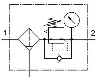
Kondensatablass vollautomatisch, mit Manometer
