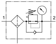
Kondensatablass halb- oder vollautomatisch, mit Manometer
