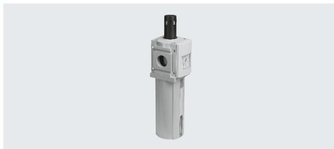
In diesem Gerät sind Filter und Druckregelventil zu einer Einheit zusammengefasst. Der Sinterfilter mit Wasserabscheider befreit die Druckluft von Schmutz, Rohrsinter, Rost und Kondenswasser.
