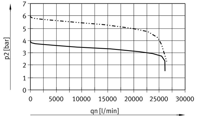
**Normaldurchfluss  $q_n$  in Abhängigkeit vom Ausgangsdruck  $p_2$  bei Betriebsdruck  $p_1 = 10$  bar**
