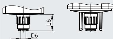
Steckanschluss für Kunststoffschlauch
