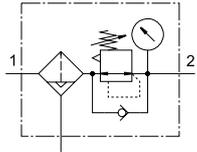
In diesem Gerät sind Filter und Druckregelventil zu einer Einheit zusammengefasst. Der Sinterfilter mit Wasserabscheider befreit die Druckluft von Schmutz, Rohrsinter, Rost und Kondenswasser.
