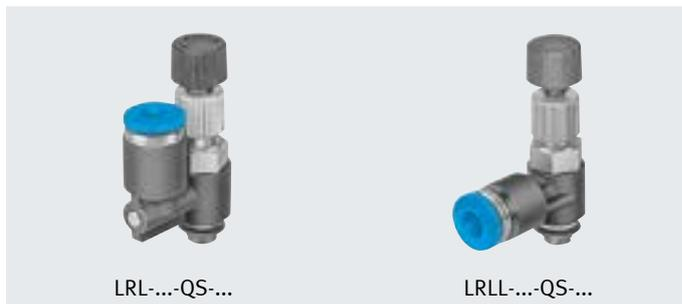
Das Differenzdruck-Regelventil regelt eine manuell eingestellte Druckdifferenz zwischen dem am Einschraubgewinde anliegenden Primärdruck und dem Ausgangsdruck am Steckanschluss.
