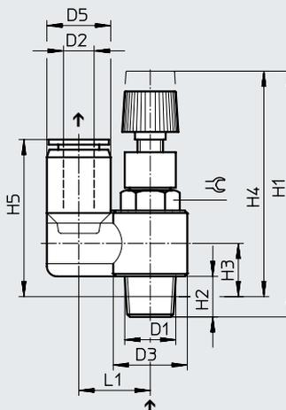
↑ Durchflussrichtung mit Druckreduzierung
