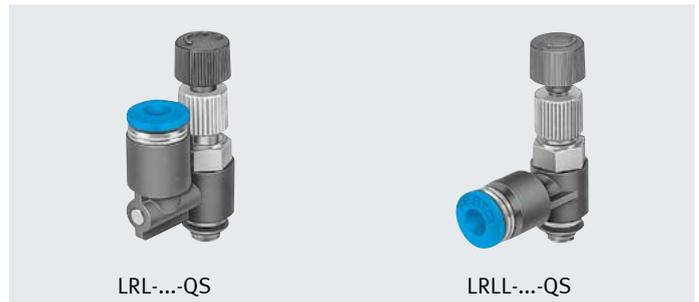
Das Differenzdruck-Regelventil regelt eine manuell eingestellte Druckdifferenz zwischen dem am Einschraubgewinde anliegenden Primärdruck und dem Ausgangsdruck am Steckanschluss.
