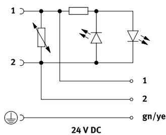
Die Ausführung für 24 V DC ist verpolungssicher und hat eine Schutzbeschaltung gegen Spannungsspitzen bis 100 V DC, sowie eine Betriebsanzeige mit gelber Leuchtdiode. (Anschluss gn/ye entfällt bei KMEB-3)
