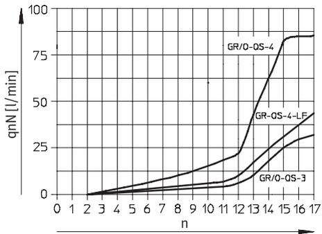
**Normaldurchfluss qn bei 6 bar → 0 bar in Abhängigkeit der Spindelumdrehungen n**
