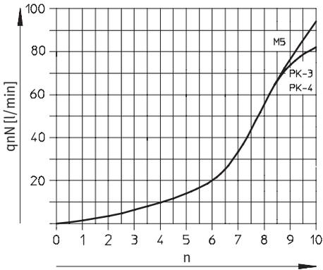
**Normaldurchfluss  $q_n$  bei 6 bar  $\rightarrow$  0 bar
