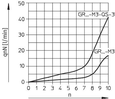
**Normaldurchfluss  $q_n$  bei 6 bar  $\rightarrow$  0 bar
