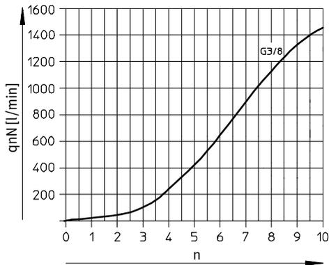
**Normaldurchfluss  $q_n$  bei 6  $\rightarrow$  0 bar
