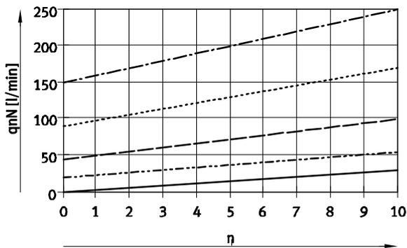
Normaldurchfluss  $q_n$  bei 6 bar  $\rightarrow$  0 bar
