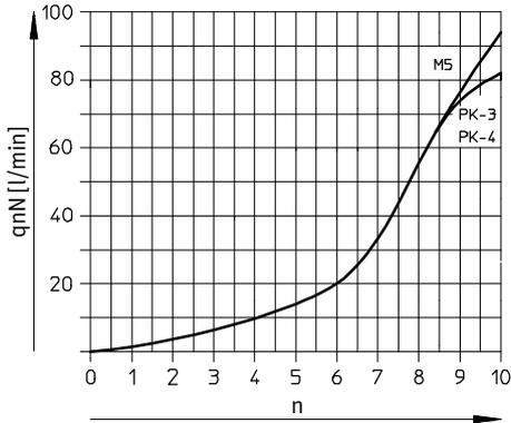
**Normaldurchfluss  $q_n$  bei 6  $\rightarrow$  0 bar
