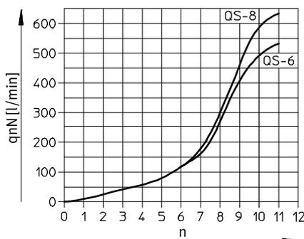
**Normaldurchfluss  $q_n$  bei 6 bar  $\rightarrow$  0 bar
