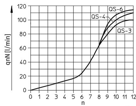
**Normaldurchfluss  $q_n$  bei 6 → 0 bar
