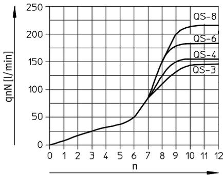
**Normaldurchfluss  $q_n$  bei 6  $\rightarrow$  0 bar
