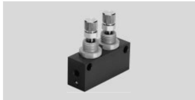
Zwei Drossel-Rückschlagventile sind in einem Gehäuse miteinander verbunden. Damit können z. B. Vor- und Rücklaufgeschwindigkeit bei einfach- oder doppelwirkenden Kleinzylindern getrennt eingestellt werden.
