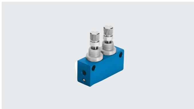
Zwei Drossel-Rückschlagventile sind in einem Gehäuse miteinander verbunden. Damit können z. B. Vor- und Rücklaufgeschwindigkeit bei einfach- oder doppelwirkenden Kleinzylindern getrennt eingestellt werden.
