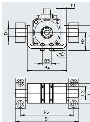
Die Position ist innerhalb der gesamten Zylinderlänge L2 frei wählbar.
