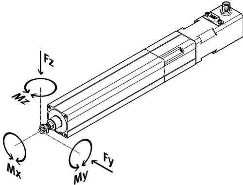
Wirken gleichzeitig mehrere Kräfte und Momente auf die Kolbenstange ein müssen folgende Gleichungen erfüllt sein:
