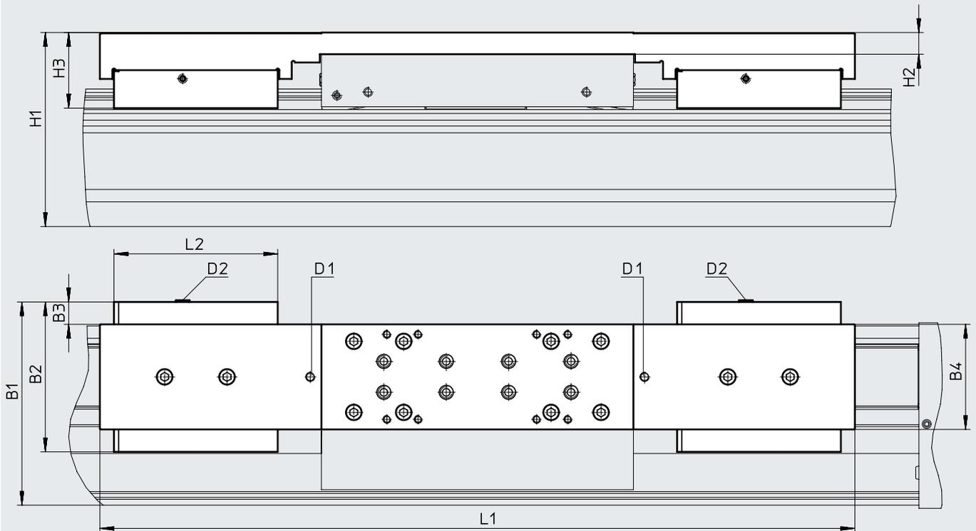
D1 Optional: Gewindeanschluss für Schmieradapter
