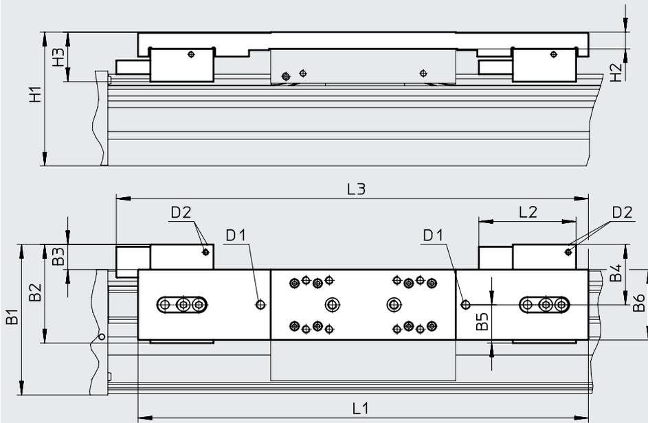
D1 Optional: Gewindeanschluss für Schmieradapter
