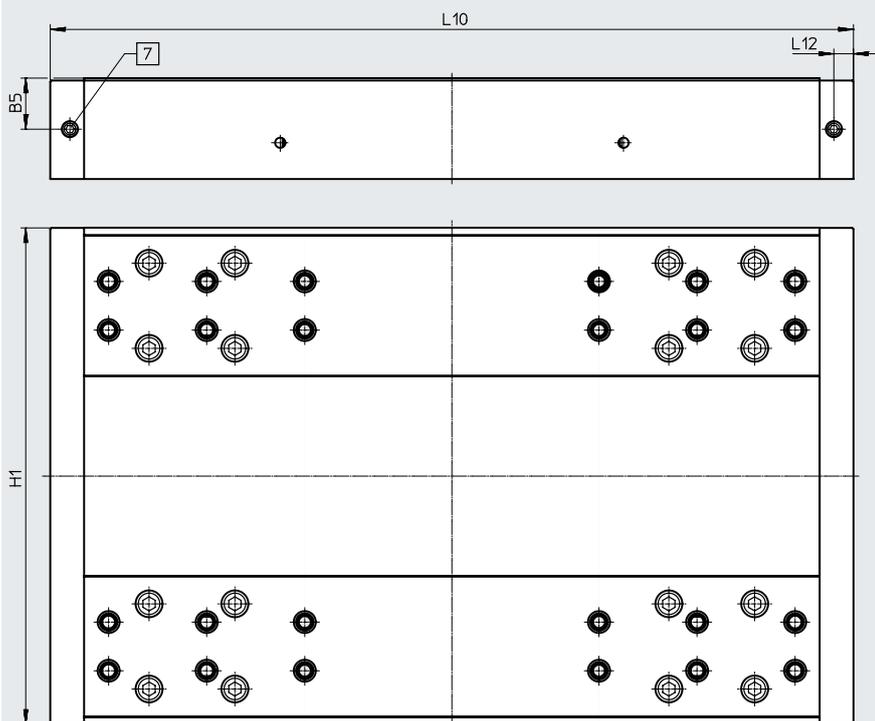
[7] Schmierbohrung für Schmieradapter Gewindeanschluss M6, 7 mm tief
