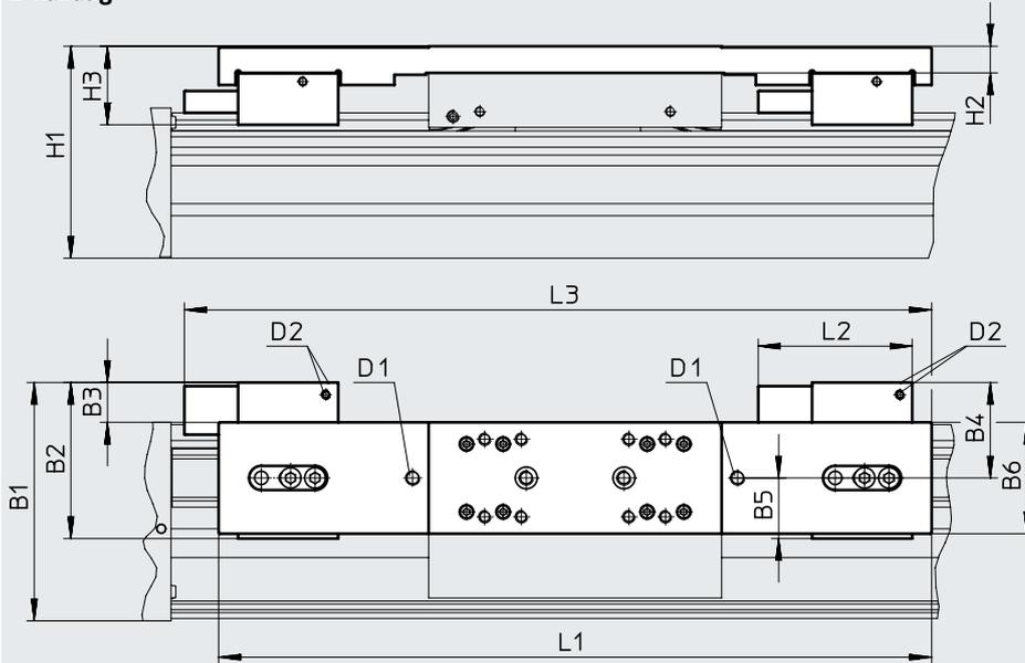
D1 Optional: Gewindeanschluss für Schmieradapter
