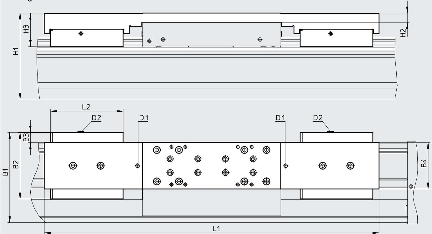
D1 Optional: Gewindeanschluss für Schmieradapter
