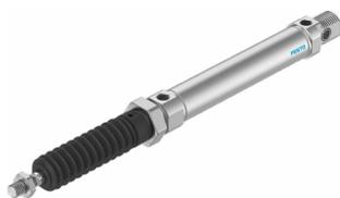
Durch den Faltenbalg werden Kolbenstange, Dichtung und Lager vor dem Einwirken unterschiedlichster Medien geschützt, was sich positiv auf dessen Lebensdauer auswirkt.
