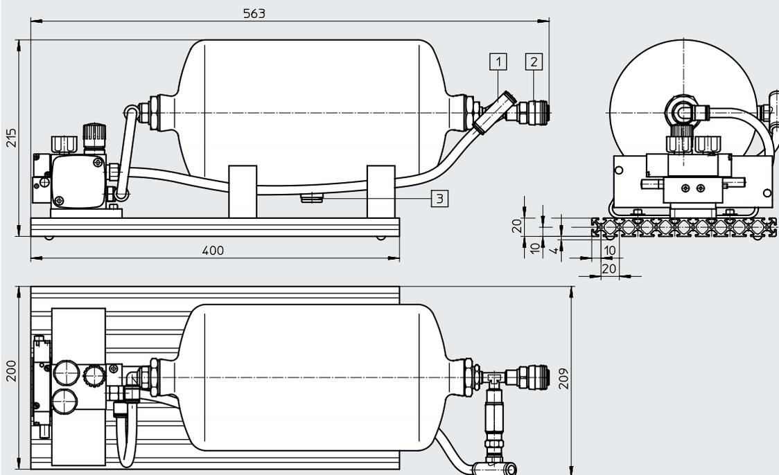
[1] Eingangsdruck p1, Anschluss QS-10
