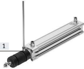
Der Faltenbalgbausatz ist ein leakage-freies System. Um das Ansaugen von unerwünschten Medien zu vermeiden, ist die Zu- bzw. Abluft des Bausatzes über eine Druckausgleichsöffnung im Anbindungsteil [1] gefasst.
