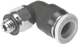
Kleinbauende Steckverschraubung für höchste Packungsdichte auf kleinstem Einbauraum. Für Pneumatikanwendungen mit einem Temperaturbereich bis 80 °C und einem Druckbereich bis 14 bar.
