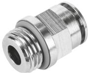
Vollmetallsteckverschraubung aus Messing, chemisch vernickelt. Hohe Korrosionsbeständigkeit KBK3 und Chemikalienresistenz. Für Pneumatikanwendungen mit einem Temperaturbereich bis 150 °C und einem Druckbereich bis 20 bar.
