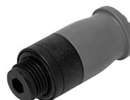
Kunststoffverschraubung für einfache Installation durch Einhandbedienung. Hydrolysebeständig, FDA konform und reinigungsfreundlich. Für Pneumatikanwendungen mit einem Temperaturbereich bis 60 °C und einem Druckbereich bis 10 bar. Schlauch-Außen- $\varnothing$  6 mm mit Anschlussgewinde G1/8.
