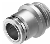
Edelstahlsteckverschraubung. Höchste Korrosionsbeständigkeit KBK4 und Chemikalienresistenz. Für Pneumatikanwendungen mit einem Temperaturbereich bis 150 °C und einem Druckbereich bis 16 bar.
