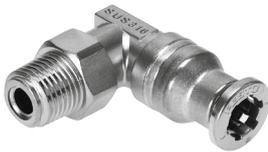
Edelstahlsteckverschraubung. Höchste Korrosionsbeständigkeit KBK4 und Chemikalienresistenz mit Zulassung in der Nahrungsmittel- und Verpackungsindustrie. Für Pneumatikanwendungen mit einem Temperaturbereich bis 120 °C und einem Druckbereich bis 10 bar.
