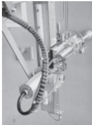
Ein strahlendes Umfeld von bis zu 4 Sievert/h und der Einsatz unter voll-entsalztem Wasser in einem Manipulator zur Zerlegung von Kernreaktor-Druckbehältern und thermischen Schilden.
