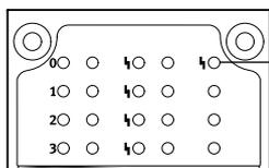
1 [1] Fehler-LED (rot; Modulfehler)
