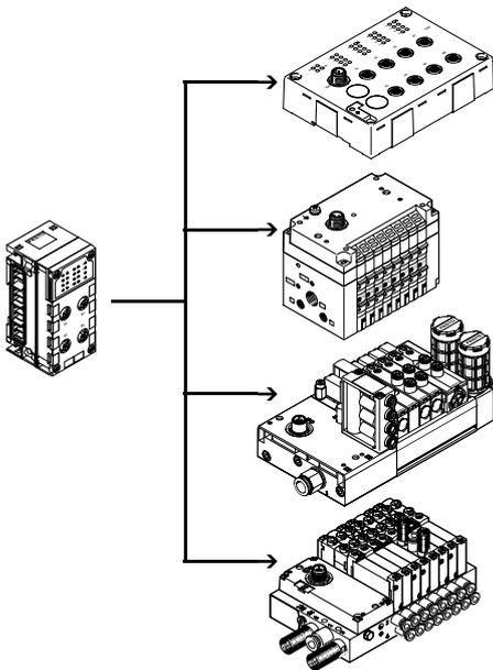
Der CPX-P CTEL-Master stellt nach außen 4 I-Port Schnittstellen bereit, an die jeweils ein Device angeschlossen werden kann. I-Port ist eine Schnittstelle für den Austausch serieller Daten zum Anschluss von dezentralen Modulen oder Ventilinseln von Festo. Die I-Port Schnittstelle basiert auf IO-Link und ist in bestimmten Bereichen damit kompatibel. Die Verbindungsart entspricht einer Stern-Topologie. Das heißt, es kann an jeden I-Port nur ein Modul oder eine Ventilinsel angeschlossen werden.
