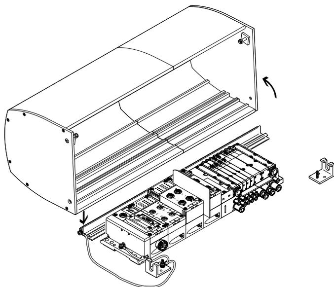
Die CPX-Haube CAFC ist eine platz- und kostensparende Alternative zu einem Schaltschrank. Sie ist als Aluminium-Strangpressprofil ausgeführt und wird auf einer Montageplatte installiert. Die Ventilinsel ist geschützt aufgebaut und schnell installiert, ohne aufwändige Schaltschrankdurchführung für Kabel und Schläuche.
