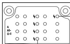
1 [1] Fehler-LED (rot; Modulfehler)
