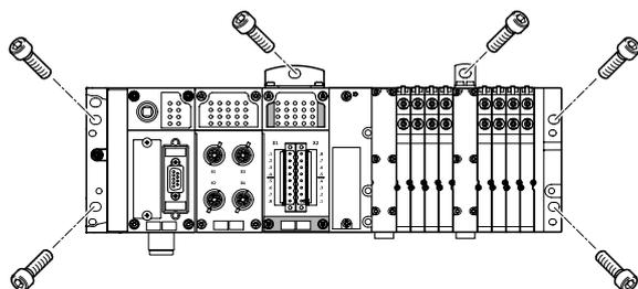
In den Endplatten des CPX-P-Terminals, der Ventilinsel und im Pneumatik-Interface sind Befestigungslöcher für die Wandmontage vorgesehen. Für längere Ventilinseln stehen zusätzliche Befestigungen für das CPX-P-Terminal zur Verfügung.
