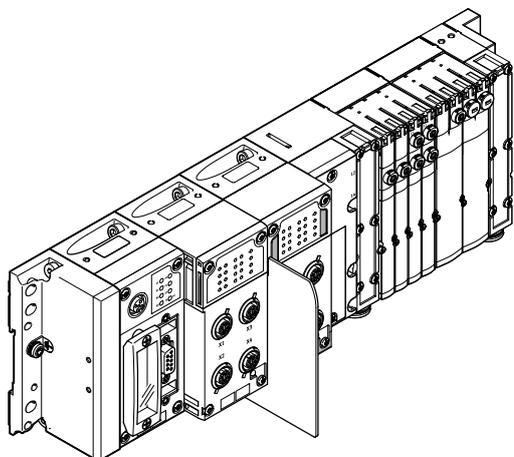
Das elektrische CPX-P-Terminal ist ein modulares Peripheriesystem für Ventilinseln.
