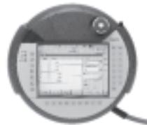
Das Bediengerät CDSA besitzt einen Not-Aus Schalter sowie einen 3-stufigen Zustimmungstaster. Beide Einrichtungen sind 2-kanalig ausgeführt und für die Integration in kundenseitigen Sicherheitskreise vorbereitet. Der Zustimmungstaster dient zur Zustimmung der Antriebsleistung im Einrichtbetrieb. Neben der Hardware, dem ergonomischen Griff, verfügt das CDSA auch über einen farbigen Touchscreen, auf dem neben der Tastatur Aktionen gestartet werden.
