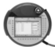
Das Bediengerät CDSA besitzt einen Not-Halt-Taster sowie einen 3-stufigen Zustimmungstaster. Beide Einrichtungen sind 2-kanalig ausgeführt und für die Integration in kundenseitigen Sicherheitskreise vorbereitet. Der Zustimmungstaster dient zur Zustimmung der Antriebsleistung im Einrichtbetrieb. Neben der Hardware, dem ergonomischen Griff, verfügt das CDSA auch über einen farbigen Touchscreen, auf dem neben der Tastatur Aktionen gestartet werden.
