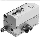
Das 5/3 Proportional-Wegeventil für Anwendungen mit Soft Stop und pneumatisch Positionieren. Voll digitalisiert – mit integrierten Drucksensoren, mit neuen Diagnosefunktionen.
