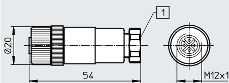
[1] Dichtung für AS-Interface-Kabel
