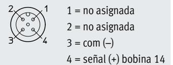
[1] Racor de conexión según EN 175301-803
