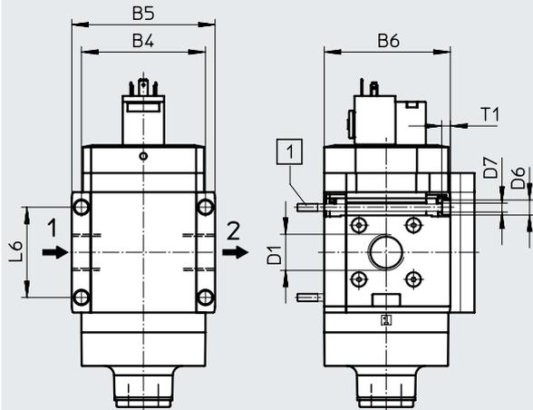
[1] Tornillo de fijación M6xmín.90 según DIN 912 (no incluido en el suministro) para el montaje mural sin escuadra de fijación → Sentido de flujo
