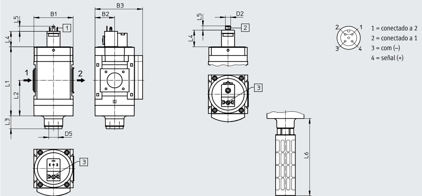
[1] Racor de conexión según EN 175301-803
