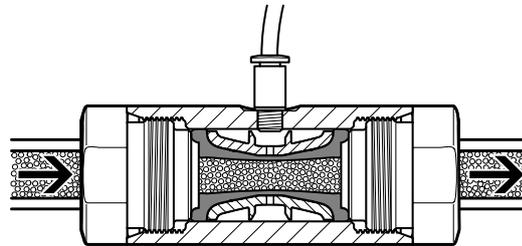
In Ruhestellung ist das Quetschventil geöffnet. Durch Beaufschlagen des Ventils mit Druckluft schließt das Quetschelement und der Stoffstrom wird abgesperrt. Das als Öffner ausgelegte Ventil öffnet nach Wegnahme der Druckbeaufschlagung durch die Eigenspannung des Quetschelementes bzw. durch den Druck des Durchflussmediums. Das Ventil erlaubt es flüssige, staubförmige Medien, Feststoffe (Granulate) sowie Stoffgemische abzusperren.
