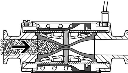
In Ruhestellung ist das Quetschventil geschlossen. Durch Beaufschlagen des Ventils mit Druckluft öffnet das Quetschelement und der Stoffstrom wird freigegeben. Das als Schließer ausgelegte Ventil schließt nach Wegnahme der Druckbeaufschlagung durch eine Feder. Das Ventil erlaubt es flüssige und gasförmige Medien abzusperren.
