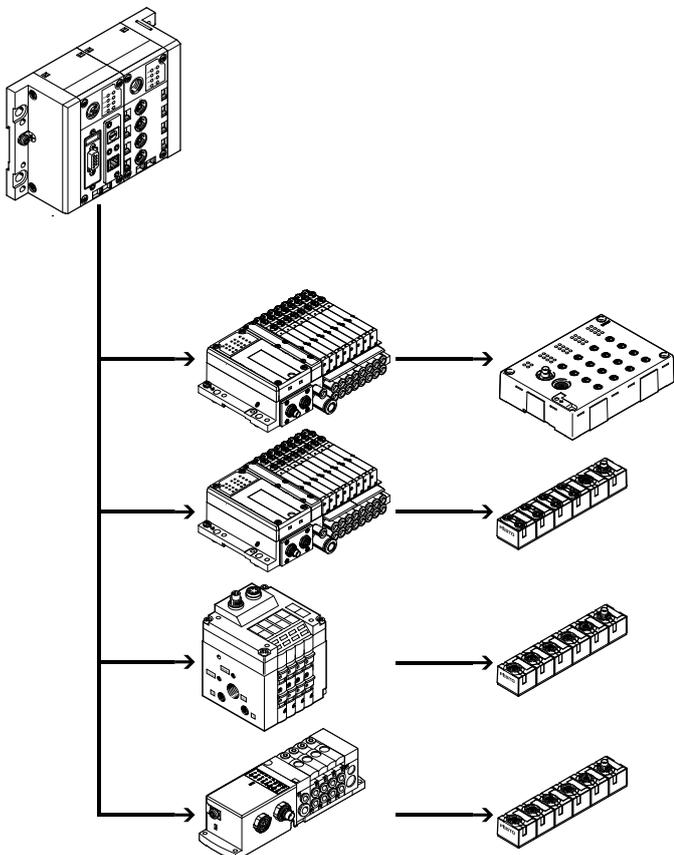
Ventilinsel für Installationssystem CPI:
