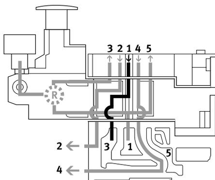
Der reversible B-Regler splittet die Arbeitsluft im Kanal 1 auf und regelt den Druck vor dem Ventil in den Kanal 3 (im Kanal 5 steht der unregelte Druck aus Kanal 1 an). Danach wird die geregelte Luft auf den Kanal 2 geregelt. Das Ventil wird dadurch reversibel betrieben.
