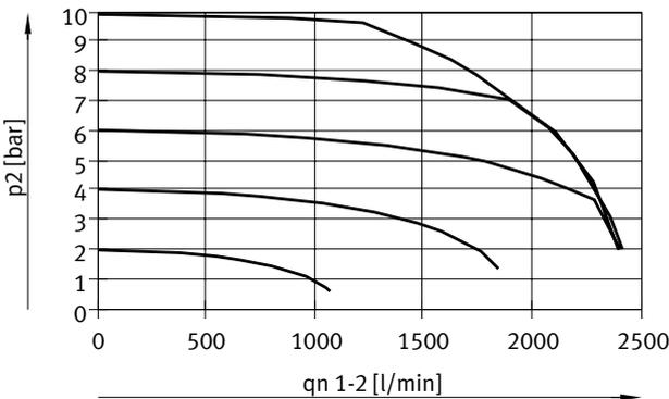
Durchfluss  $q_n$  von 2 → 3 in Abhängigkeit vom Ausgangsdruck  $p_2$
