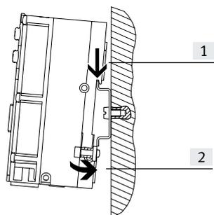
Die MPA Ventilinsel wird in die Hutschiene eingehängt → Pfeil [1]. Danach wird die MPA Ventilinsel auf die Hutschiene geschwenkt und durch das Klemmstück befestigt → Pfeil [2].
