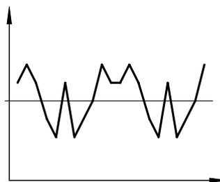
Wiederholgenauigkeit ist die Spanne, innerhalb derer die fluidische Ausgangsgröße streut, wenn dasselbe elektrische Eingangssignal, aus derselben Richtung kommend, wiederholt eingestellt wird. Die Wiederholgenauigkeit wird in % des maximalen fluidischen Ausgangssignals angegeben.
