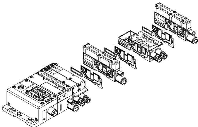
Die modulare Bauweise der MPA ermöglicht eine hohe Flexibilität bereits im Planungsstadium und bietet höchste Servicefreundlichkeit im Betrieb. Das System besteht aus Anschlussplatten und Ventilen.
