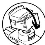
HHB mit Arretierung auf Vorsteuerventil aufclipsen. Danach kann die Kappe der HHB rastend ohne Werkzeug betätigt werden. Ventile können im Ventilinselkonfigurator, im Auswahlmenu Handhilfsbetätigung, bereits mit Abdeckkappe bestückt bestellt werden (Code Y).
