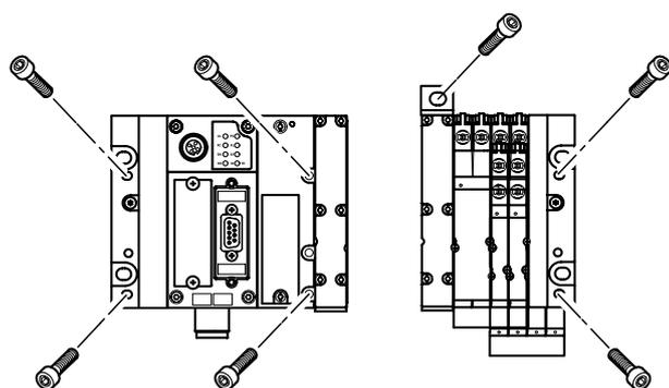
Die MPA Ventilinsel wird mit sechs M4- oder M6-Schrauben auf der Befestigungsfläche angeschraubt. Die Montagebohrungen befinden sich an der linken Endplatte (CPX) und an der rechten Endplatte MPA.
