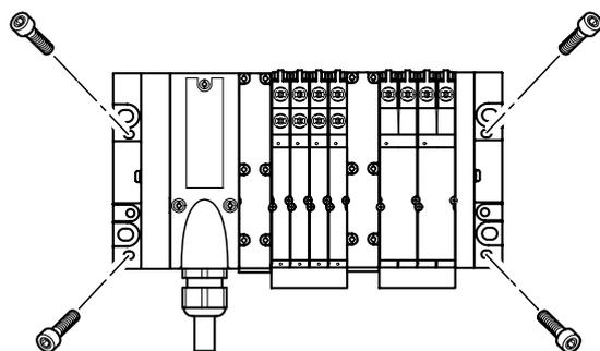
Die MPA Ventilinsel wird mit vier M4- oder M6-Schrauben auf der Befestigungsfläche angeschraubt. Die Montagebohrungen befinden
