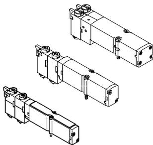
MPA bietet umfangreiche Ventilfunktionen. Alle Ventile sind mit patentiertem Dichtprinzip ausgestattet welches hohe Dichtheit, einen großen Druckbereich und lange Lebensdauer ermöglicht. Sie besitzen zur Leistungssteigerung eine pneumatische Vorsteuerung. Die Versorgung erfolgt über eine Steuerluftversorgung.
