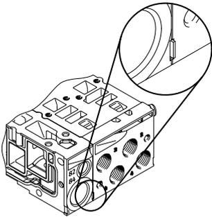
Werden unterschiedliche Arbeitsdrücke benötigt, so bietet MPA vielseitige Möglichkeiten zum Aufbau von Druckzonen. Je nach elektrischer Anschaltung sind bis zu 16 Druckzonen möglich. Eine Druckzone wird durch die Auftrennung der internen Versorgungskanäle zwischen den Anschlussplatten mit einer entsprechenden Trenndichtung oder durch eine in der Anschlussplatte fest integrierte Trennung (Code I oder Code III) erreicht.
