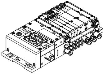
Die Kommunikation zu einer übergeordneten SPS übernimmt ein integrierter Feldbusknoten. Somit lässt sich eine Lösung kleinbauend in Pneumatik und Elektronik realisieren.
