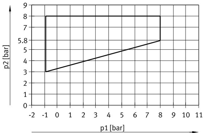
für Ventile in Baubreite 20 mm mit Code: MS, NS, KS, HS, DS
