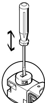
HHB wird durch Drücken mit Stift oder Schraubendreher betätigt und über Federkraft zurückgestellt (rastende Stellung wird durch codierte Abdeckkappe verhindert). Ventile können im Ventilinselkonfigurator, im Auswahlmenu Handhilfsbetätigung, bereits mit Abdeckkappe bestückt bestellt werden (Code N).
