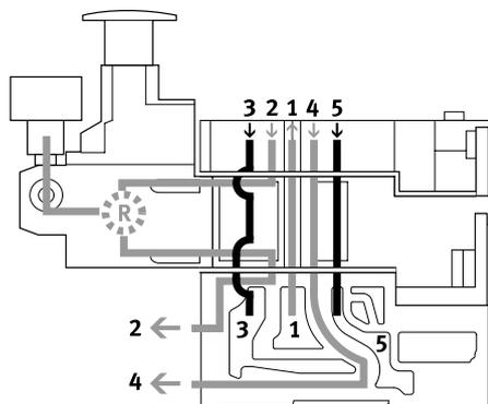
Dieser Druckregler regelt den Druck im Kanal 2 nachdem das Druckmedium durch das Ventil geströmt ist. Beim Entlüftungsvorgang wird im Ventil über den Druckregler von Kanal 2 nach Kanal 3 entlüftet.
