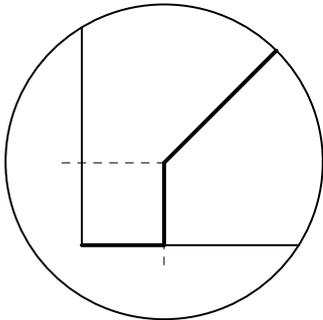
In der Praxis besteht die Möglichkeit, dass am Sollwerteingang des VPPM über den Sollwertgeber eine Restspannung oder ein Reststrom anliegt. Damit das Ventil bei Sollwert Null mit Sicherheit entlüftet, nutzt man die Nullpunktunterdrückung.
