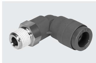
Flammhemmende Steckverschraubung für den Einsatz in allen brandgefährdeten Bereichen, wie zum Beispiel Schweißanlagen in der Automobilindustrie, sowie Gebäudebau. Für Pneumatikanwendungen mit einem Temperaturbereich bis 60 °C und einem Druckbereich bis 10 bar. Schlauch-Außen- $\varnothing$  4, 6, 8, 10, und 12 mm mit Anschlussgewinde R1/8 ... R1/2 und G1/8 ... G1/2.
