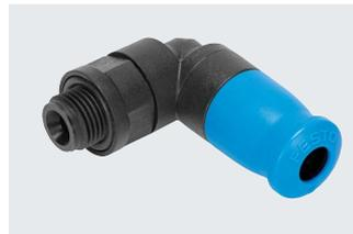
Kunststoffverschraubung für einfache Installation durch Einhandbedienung. Hydrolysebeständig, FDA konform und reinigungsfreundlich. Für Pneumatikanwendungen mit einem Temperaturbereich bis 60 °C und einem Druckbereich bis 10 bar. Schlauch-Außen- $\varnothing$  6 mm mit Anschlussgewinde G1/8.
