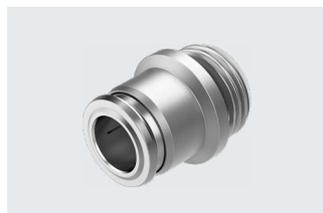
Edelstahlsteckverschraubung. Höchste Korrosionsbeständigkeit KBK4 und Chemikalienresistenz. Für Pneumatikanwendungen mit einem Temperaturbereich bis 150 °C und einem Druckbereich bis 16 bar. Schlauch-Außen- $\varnothing$  4, 6, 8, 10 und 12 mm mit Anschlussgewinde M5, M7 und G1/8 ... G1/2.
