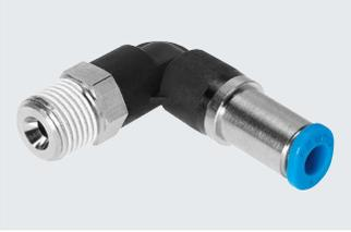
Steckverschraubung sperrt Luftstrom nach dem Lösen des Schlauchs. Für Pneumatikanwendungen mit einem Temperaturbereich bis 60 °C und einem Druckbereich bis 14 bar. Schlauch-Außen- $\varnothing$  4, 6, 8, 10 und 12 mm mit Anschlussgewinde M5, R1/8 ... R1/2 und G1/8 ... G1/2.
