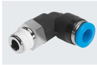
Breite Auswahl an Steckverschraubungen für Pneumatikanwendungen mit einem Temperaturbereich bis 80 °C und einem Druckbereich bis 14 bar. Schlauch-Außen- $\varnothing$  4, 6, 8, 10, 12, 16 und 22 mm mit Anschlussgewinde von R1/8 ... R1/2 und G1/8 ... G3/4.
