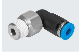
Steckverschraubung mit Schwenkanschluss, 360° rotierend. Das Kugellager ermöglicht rotierende Bewegungen in der Anwendung bis max. 500 U/min. Für Pneumatikanwendungen mit einem Temperaturbereich bis 60 °C und einem Druckbereich bis 14 bar. Schlauch-Außen- $\varnothing$  4, 6, 8, 10 und 12 mm mit Anschlussgewinde M5, R1/8 ... R1/2 und G1/8 ... G1/2.
