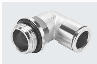
Metallsteckverschraubung zum attraktiven Preis für Pneumatikanwendungen mit einem Temperaturbereich bis 70 °C und einem Druckbereich bis 16 bar. Schlauch-Außen- $\varnothing$  3, 4, 6, 8, 10, 12 und 14 mm mit Anschlussgewinde M5, M7 und G1/8 ... G1/2.
